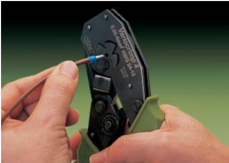
Вставить проводник с наконечником в обжимающую цангу.
