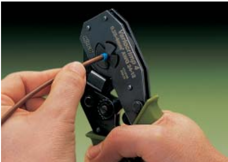
Сжать ручки до освобождения храпового механизма.
